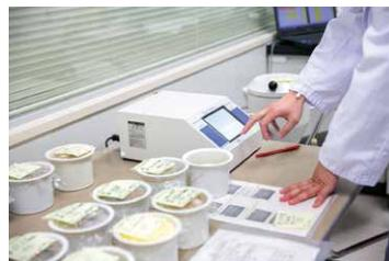
シンチレーション検出器によるモニタリングの様子。放射能検査は毎日12~13もの検体を測定し、結果は随時ホームページで発表している。
